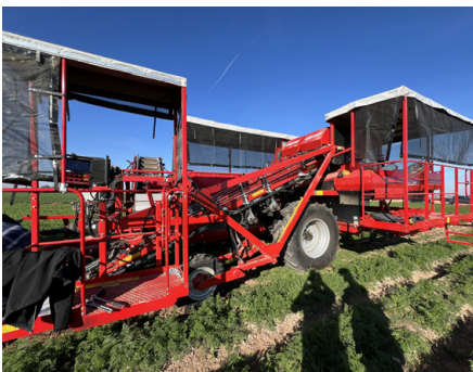
T-200DF Getrokken, tweerijige oogstmachine. Oogst van wortelen voor latere zaaizaadproductie.
