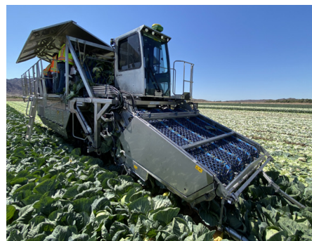
SP-400 Kool Vierrijige kooloogstmachine met rupsonderstel. Rijenafstand 50 cm / 19 inch. Reinigingssysteem voor industrie verwerkte kool. Verstek overlaadelevator voor perfecte vulling van kisten.
