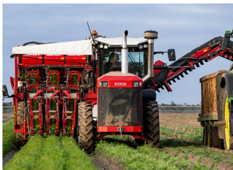
SP-305 3-rijige oogstmachine voor wortelen met overlaadelevator. Alle vijf wielen zijn bestuurbaar en worden hydraulisch aangedreven. Egelband voor reiniging. Messenunit voor loofscheiding.
