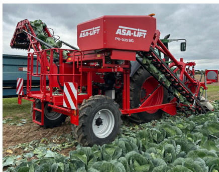
PO-335 SG Gedragen, 1-rijige klembandrooier. Overlaadelevator. Voor de oogst van groene kool en voorjaarsgroente. Platform bij de leestafel voor twee personen.
