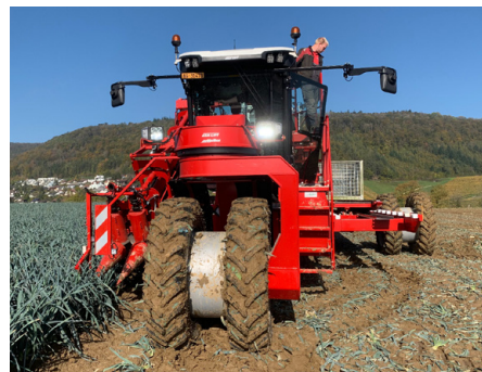
SP-110PO Zelfrijdende 1-rijige oogstmachine voor prei. Automatische vulling van kisten Kistenplatform, die tot 6 volle kisten kan meenemen. Verzette cabine voor beter zicht.
