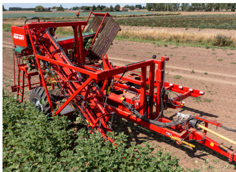
T-100SF Getrokken, 1-rijige oogstmachine voor bloemen Kistenmagazijn. Kisten kantelinrichting voor productvriendelijk vullen.
