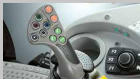
Comfortip wendakkermanagement, 4 vrij programmeerbare toetsen, rijrichtingwissel en hefinrichting op de MaxCom joystick bijeen gebracht.
