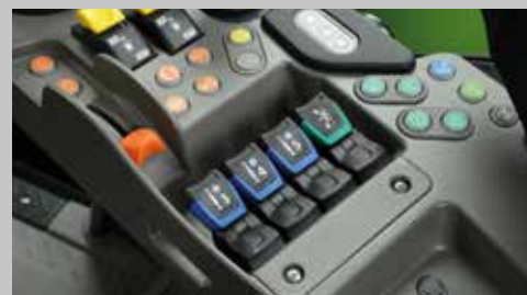
MaxCom bedieningspaneel met o.a. bediening ventielen en aftakas(sen)
