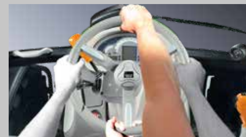
Halvering van het aantal stuuromwentelingen met het SDD snelstuursysteem
