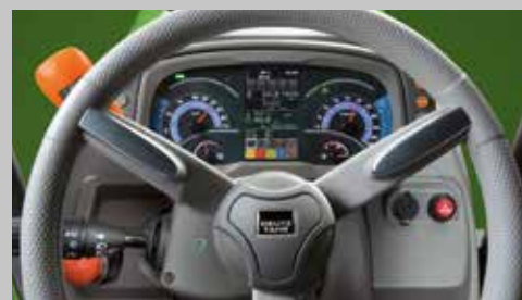
Verstelbare stuurkolom met meebewegend dashboard voor optimaal zicht
