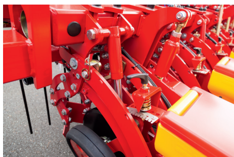
Zaai-element met mechanische of hydraulische drukbelasting tot 90 kg
