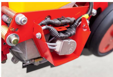
Elektrische aandrijving voor flexibele zaai afstanden, Section Control
