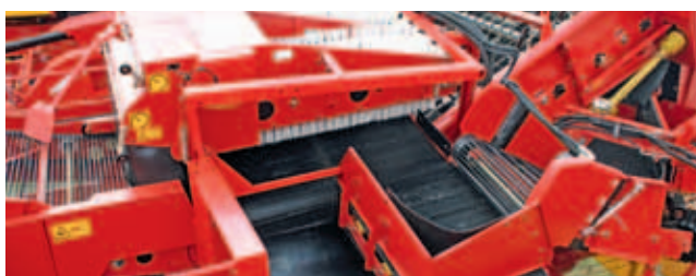
Type SB: beste reinigingsresultaten op gronden met veel stenen dankzij de innovatieve kinetische stenenscheider
