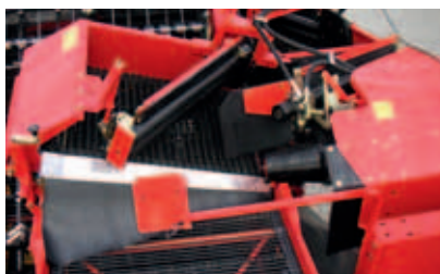
Type NB: met 3e egelband en 3e afstrijkrol – voor nog betere prestaties op gemakkelijk afzeefbare gronden
